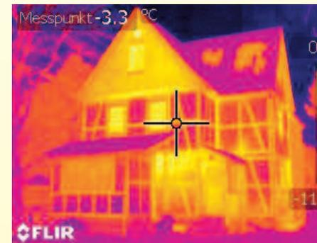
Wärmebrücken bzw. hohe Wärmeabstrahlung sind bei den Außenaufnahmen an einer helleren Färbung erkennbar. Die höhere Oberflächentemperatur deutet auf höhere Verluste über diese Flächen hin.
